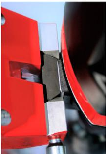
Maschine komplett in Schnellaufnahme einsetzen. Arretieren bzw. Lösen durch Drehen der Knebelschraube. (Wahlweise auch mit herkömmlicher Motorhalsaufnahme lieferbar)
